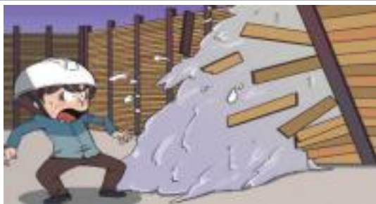
지반 연약화로 인한 흙막이 지보공 무너짐
